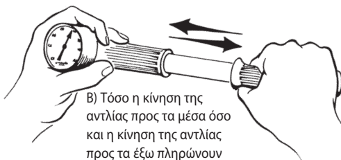
Εικόνα 3. Λειτουργία της αντλίας χειρός
